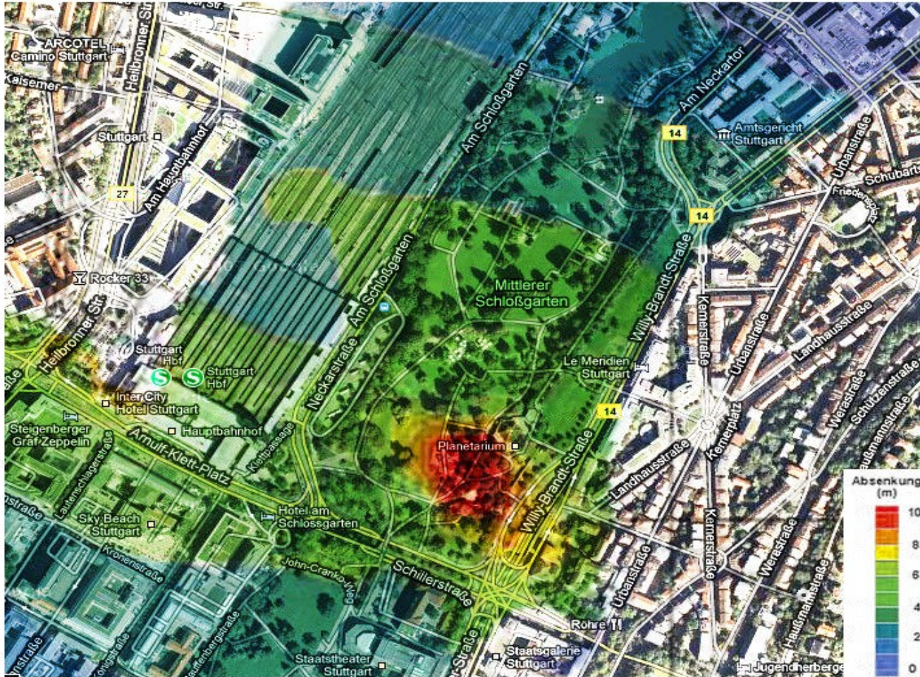
Grundwasserabsenkung mit Infiltration: Absenktrichter mit erheblich geringerer Flächenausdehnung. Simulation nach Kobus und Partner
